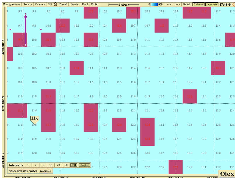
Cellules douteuses éliminées et régénération automatique de l'interpolation
