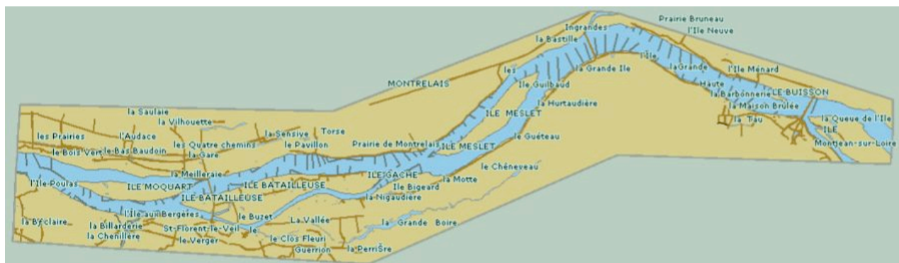
Vue du fichier DXF converti au format S-57 (avec remplissage des surfaces)
